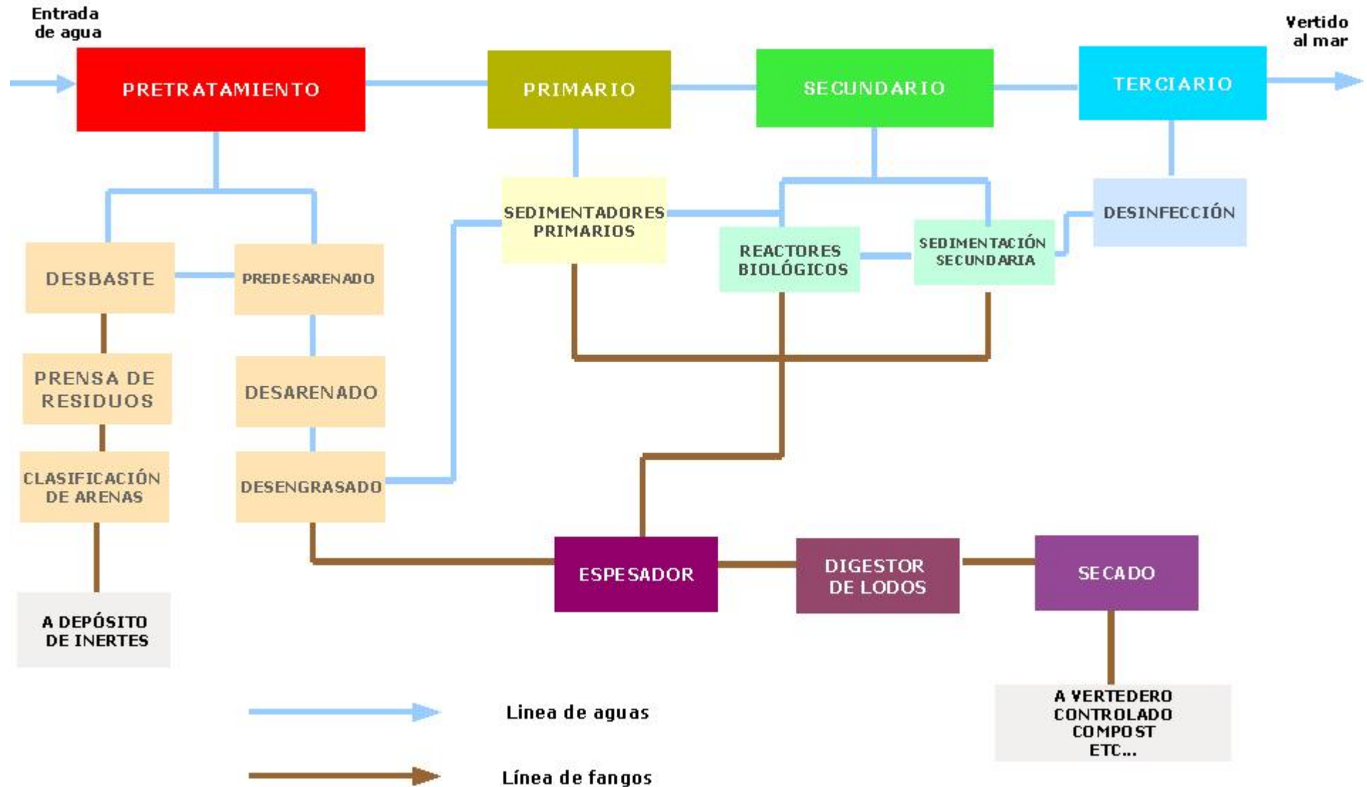
Diagrama de flujo del tratamiento de aguas residuales
