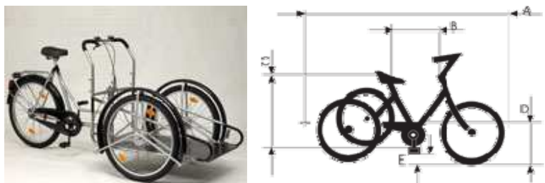
Imagen 60. Modelo de triciclo de transporte puede transportar una carga de superficie de carga: 800 mm x 600 mm x 250 mm con un peso de hasta: 150 kg 23 .
