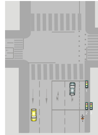
Imagen 47. Intersección semaforizada con fase específica para ciclistas (Fuente 7).
