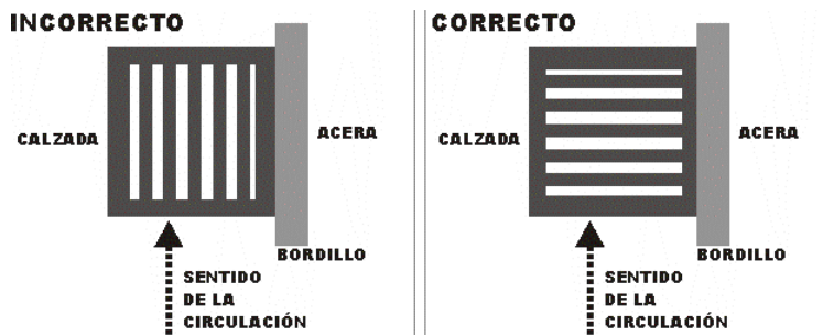
Imagen 53. Colocación de tapas de alcantarillado.
